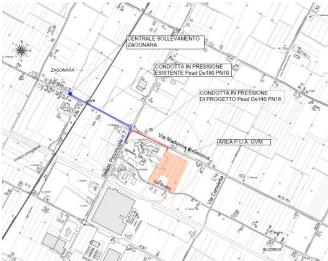
Figura 5: Inquadramento nuovo premente privato esterno al PUA e premente esistente privato con rilancio al sollevamento pubblico di Zagonara.
